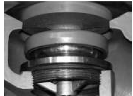
Профилированное седло и затвор из нержавеющей стали
